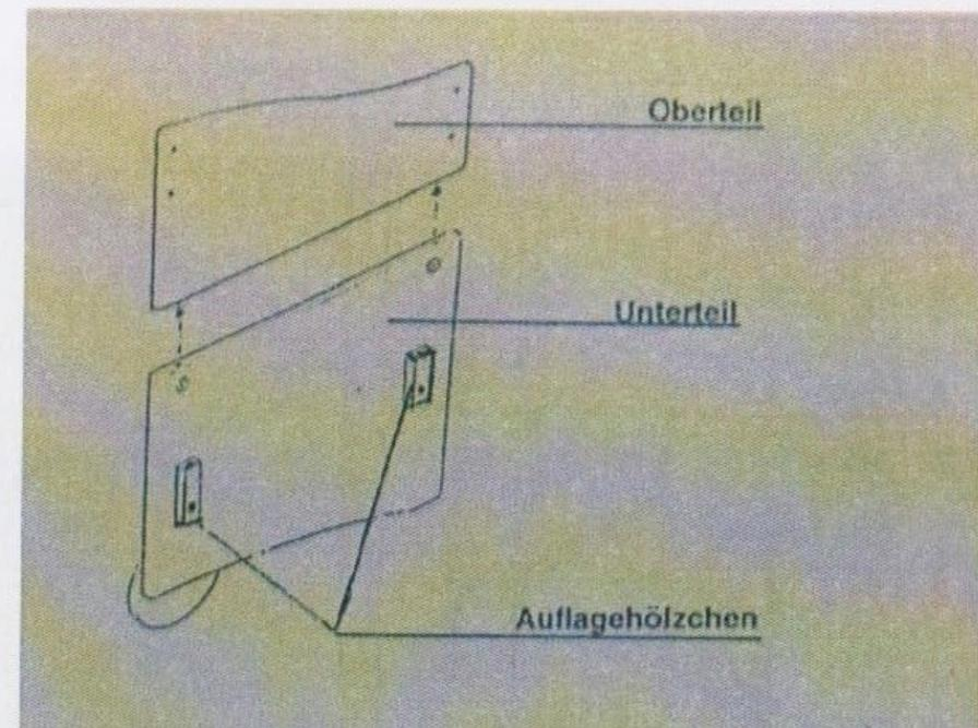
5. Die Verbindungsbolzen nach Zeichnung in die Stirnseiten einschrauben.
