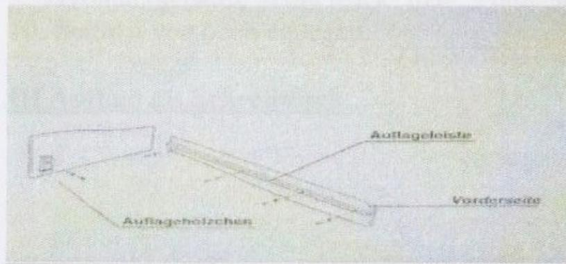
1. Auflageleiste von dem Bettgitter zur Vorderseite mittels 4 Innensechskant- (Imbus-) Schrauben incl. Unterlegscheiben ummontieren
